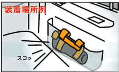
ガラス破碎先端部
